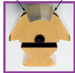
逆回転時の切刃 正回転時の切刃
