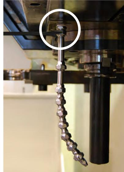
⑤最後にノズルの向きを調整して下さい。
