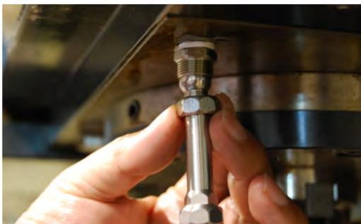
④付属のレンチでナットをしっかりと締め付けて下さい。
