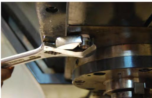
③次に接続するジョイントホースをコネクターのR部分に押し当てた後、ナットを仮締めして下さい。
