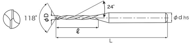
超微粒子 左ねじれ 24° 先端角 118° 刃数2 直径許容差 0~-0.009
