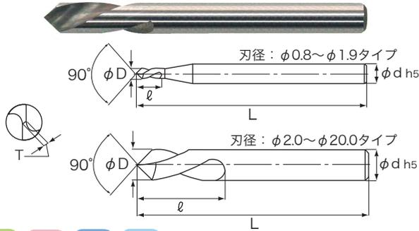
超微粒子 左ねじれ 24° 先端角 90° 刃数2 直径許容差 0~0.012 (単位:mm)
