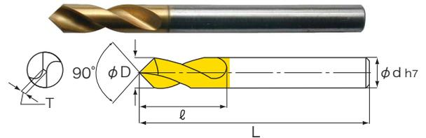
HSS-Co TiNコート 右ねじれ 24° 先端角 90° 刃数2 直径許容差 0~0.012 (単位:mm)
