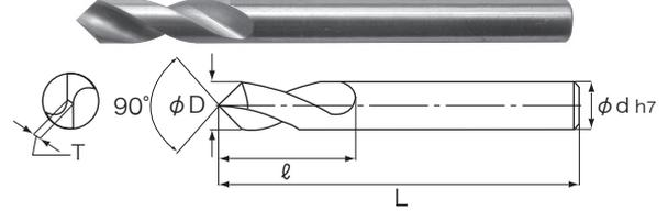
HSS-Co 右ねじれ 24° 先端角 90° 刃数2 直径許容差 0~0.012 (単位:mm)
