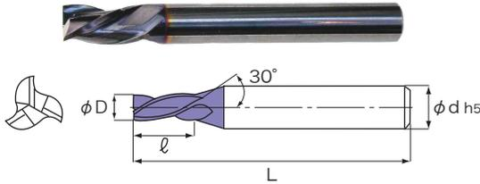
超微粒子 TiAlN系コート 左ねじれ 30° 刃数3 ピン角 刃径許容差
