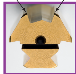
逆回転時の切刃 正回転時の切刃
